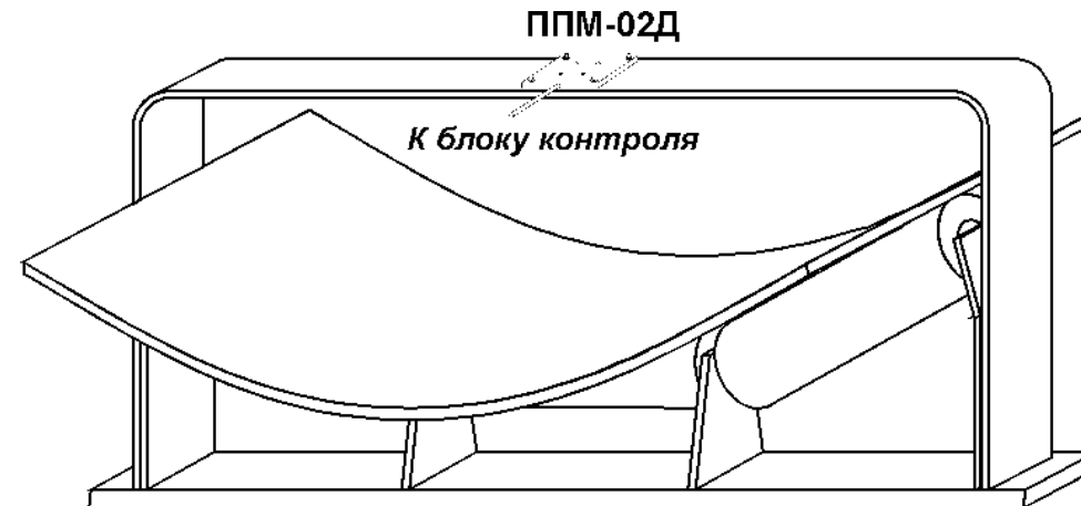
Рис. 9. Контроль наличия продукта на движущейся ленте конвейера.
